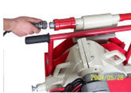
6.3.4. Установить соответствующие вкладыши в центратор в соответствии с внешним диаметром труб / фитингов.
