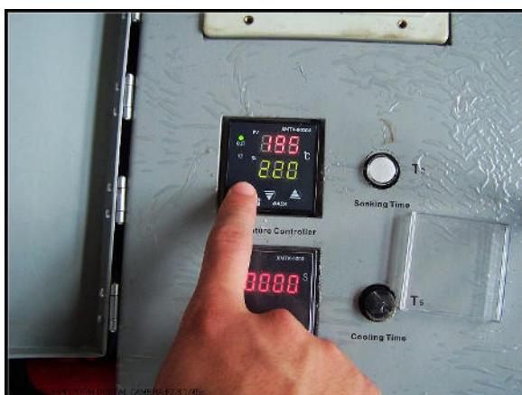
4. При стабильной температуре 220 градусов на дисплее, повторно проверьте температуру поверхности нагревательного элемента. Если все еще существует отклонение температуры, то повторите описанную выше операцию по корректировке температуры еще раз.
