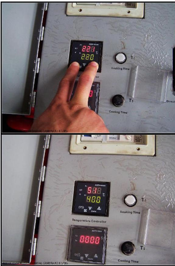
В. Нажмите кнопку "SET" дважды, на дисплее отобразится нижеследующий рисунок:
